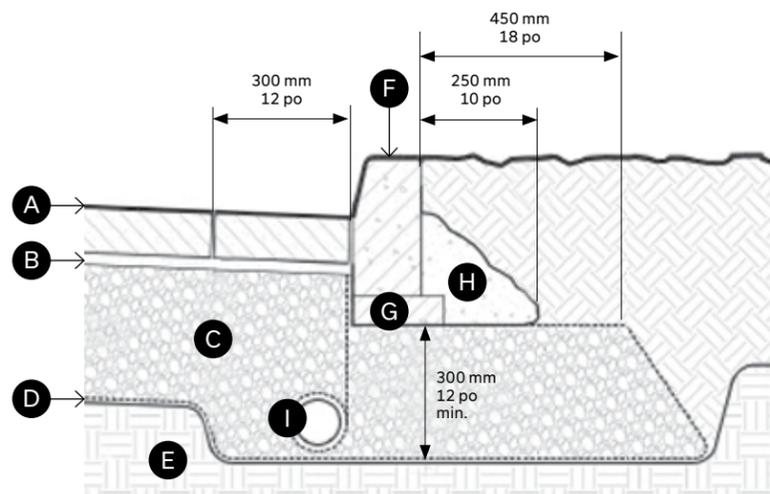
**Pavés et bordure de béton préfabriqués chaussée et trottoir**
