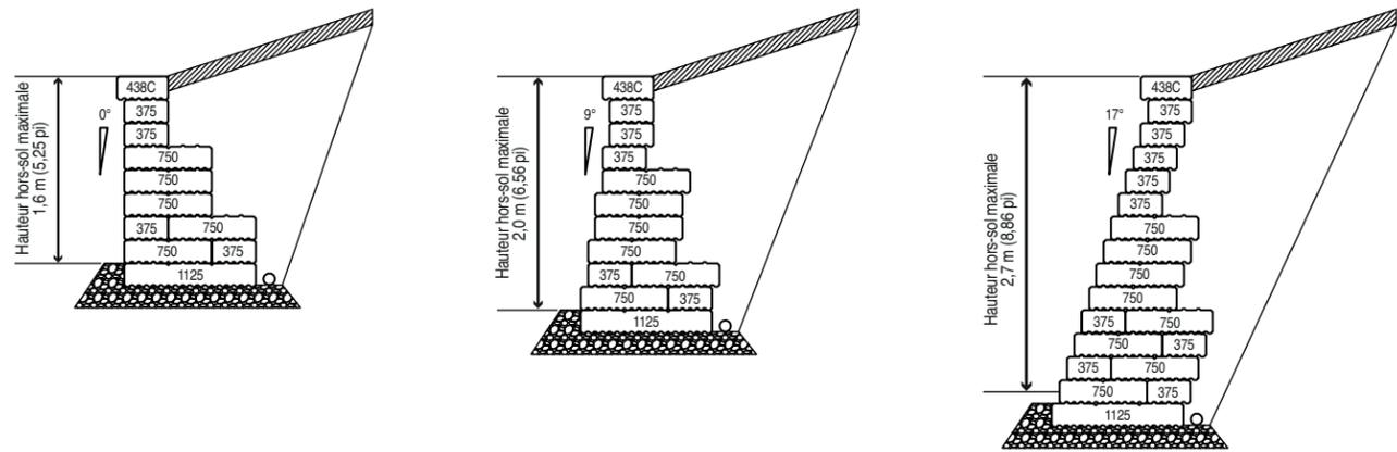
Murs avec talus de différentes inclinaisons (pente maximale du talus 1 vertical : 3 horizontal)
