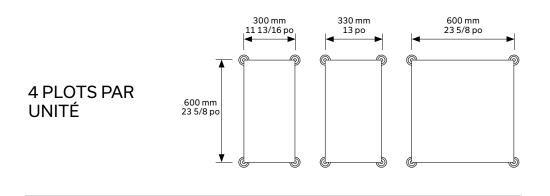
Les tuiles de porcelaine installées sur les plots doivent être munies d'une plaque d'acier galvanisée installée en usine.
