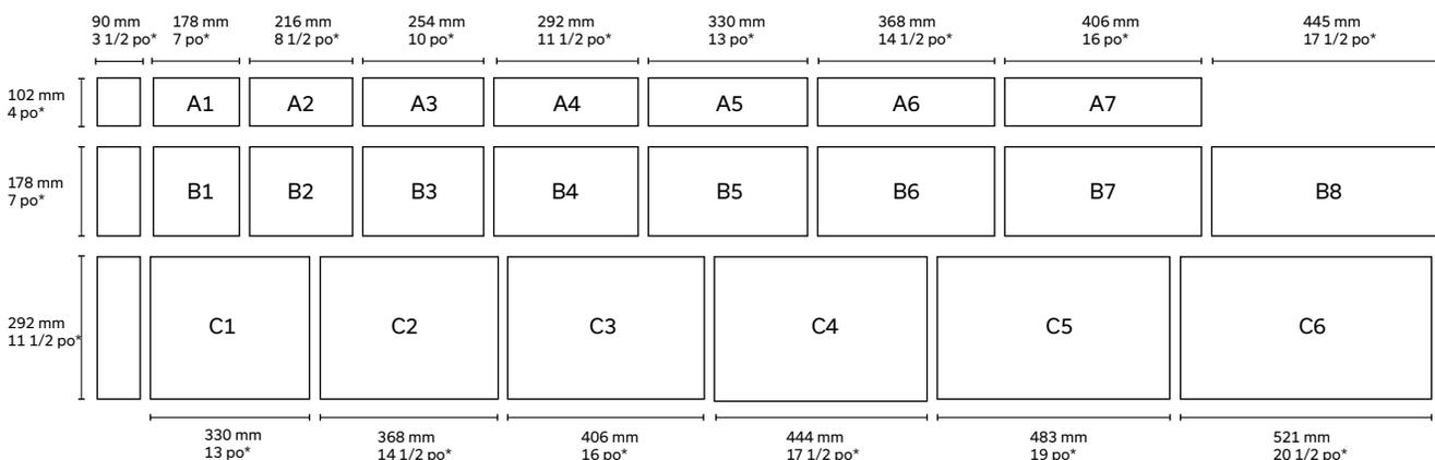
\* Ces dimensions sont réelles. Prévoir un joint de 1/2 po - 13 mm pour respecter la modularité et obtenir les dimensions nominales.
