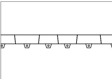
Pour réaliser une ligne droite, alignez les bordures en alternant les côtés à angle.
