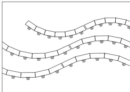
Pour réaliser une courbe concave ou convexe, déposez les bordures en utilisant les angles du même côté.
