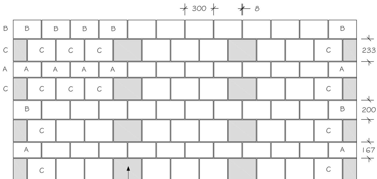
Les vides sont comblés manuellement avec des pavés C
