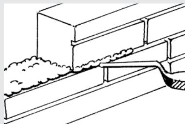
Afin de s'assurer que tous les joints de mortier aient la même couleur, lissez ceux-ci lorsqu'ils ont la même fermeté. Il est à noter que plus les joints sont fermes lorsqu'ils sont lissés, plus la couleur sera foncée.
