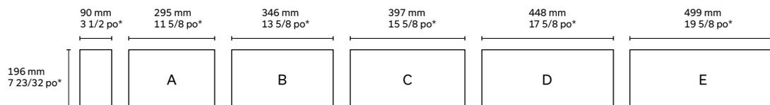
\* Ces dimensions sont réelles. Prévoir un joint de 3/8 po - 10 mm pour respecter la modularité et obtenir les dimensions nominales.
