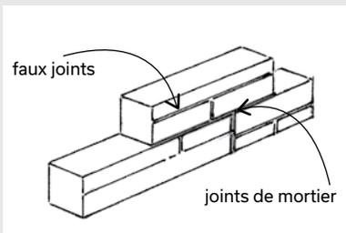
Identifiez les faux joints et les joints de mortier. Idéalement, les joints de mortier et les faux joints devraient être de la même épaisseur.
