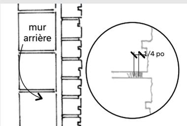
Afin que tous les joints de mortier et les faux joints aient la même profondeur, raclez et lissez un joint en retrait de 6 mm (1/4 po) d'épaisseur par rapport à la pierre la plus profonde.
