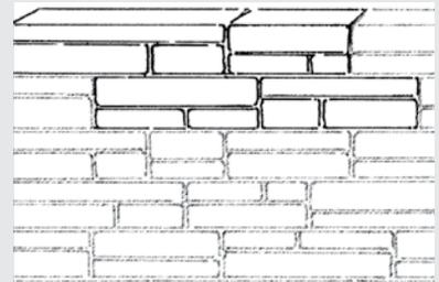
La pierre Lamina est installée comme tout autre parement de maçonnerie conventionnelle. Les unités devraient être installées de façon aléatoire.
