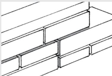
Réalisez un joint de mortier d'environ 6 mm (1/4 po) d'épaisseur afin d'obtenir une apparence uniforme.
