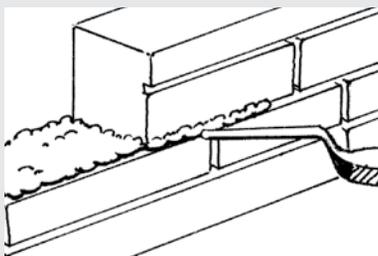
Afin de s'assurer que tous les joints de mortier aient la même couleur, lissez ceux-ci lorsqu'ils ont la même fermeté. Il est à noter que plus les joints sont fermes lorsque lissés, plus la couleur sera foncée.
