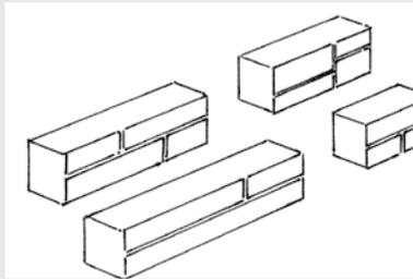
Pour faciliter l'installation, toutes les pierres mesurent 90 mm (3 1/2 po) de profondeur réelle et 95,25 mm (3 3/4 po) de hauteur réelle.
