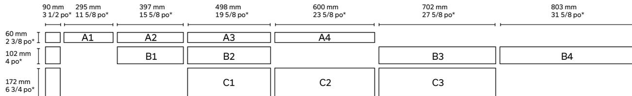
\* Ces dimensions sont réelles. Prévoir un joint de 3/8 po - 10 mm pour respecter la modularité et obtenir les dimensions nominales.
