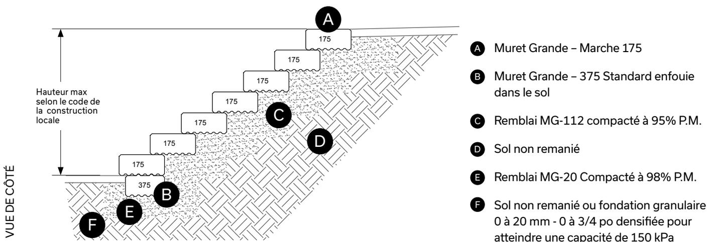
Les hauteurs maximales des murs supposent qu'il y a une surcharge de 2,4 kPa et aucune pente derrière le mur, et que le mur retient du sable ou du gravier net ( $\phi = 34$  degrés,  $\gamma = 21$  kN/m<sup>3</sup>).
