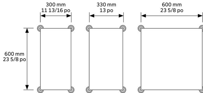
Les tuiles de porcelaine installées sur les plots doivent être munies d'une plaque d'acier galvanisée installée en usine.
